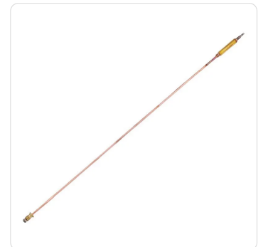
Thermoelement: 1 Spitze – sitzt in der Flamme. 2 Verschraubung am Ventil – bei Problemen handfest nachziehen.
